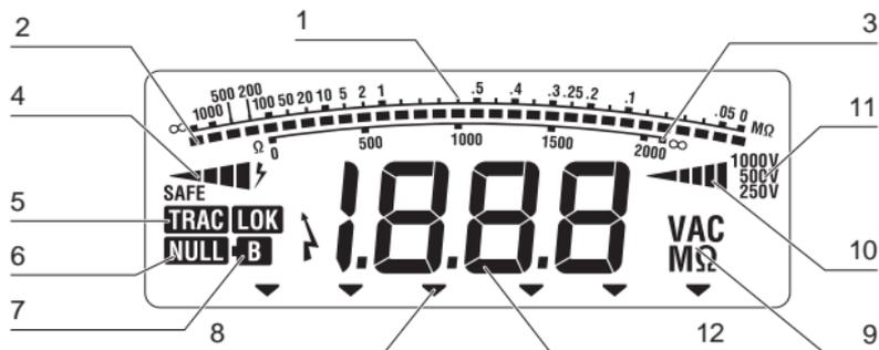
1... INSULATION RESISTANCE SCALE
